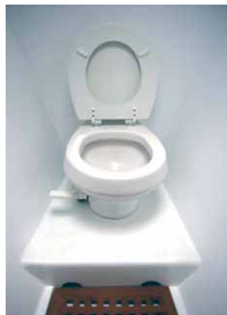
Рис.9. Гальюн в носовой части катамарана. Является частью вакуумной системы «Dometic». Низкая компактная модель установлена на ступеньке.
