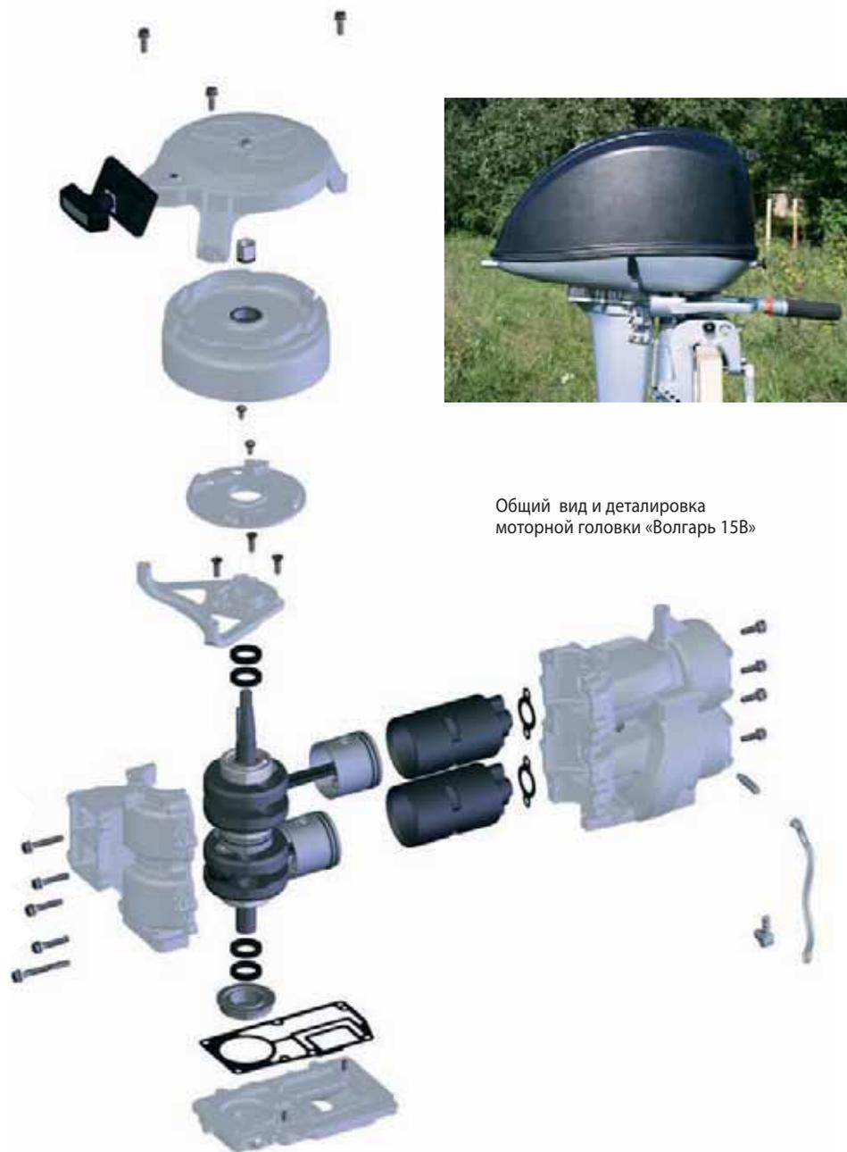
Общий вид и детализовка моторной головки «Волгарь 15В»
