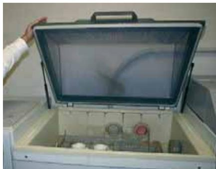
Корпусные детали рулевых машинок испытывают на стойкость к низким температурам и соленой воде
