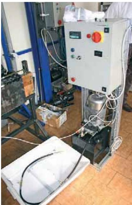
Лабораторный стенд сотни тысяч раз проворачивает шпindelь рулевой машинки
