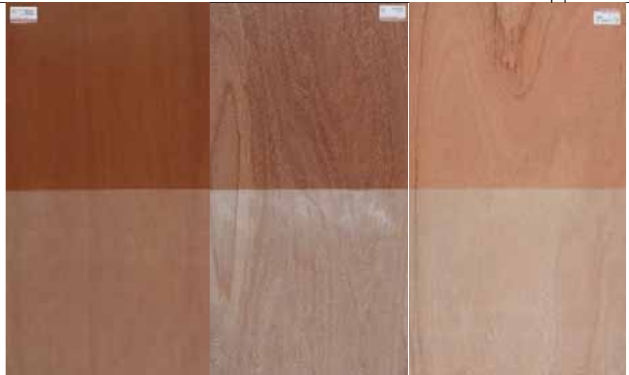
Образцы фанеры для судостроения (слева направо): «лауро», «меранти», «окуме»; верхняя половина покрыта лаком, нижняя необработанная
