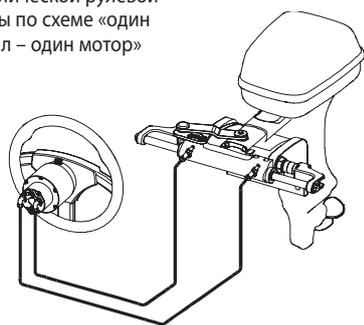
Цилиндры двухмоторной установки также соединяются параллельно и при расчетах их объемы суммируются
