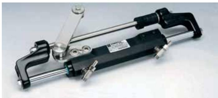
**В**о-первых, сопротивление перемещению жидкости по трубопроводам этой системы несравнимо ниже, чем перемещению троса внутри спиральной оболочки, а значит, потери на трение при передаче усилия на руль будут минимальны. Это дает основания применять гидравлику на судах большой длины, с постом управления, далеко отнесенным от руля либо поворотного движителя.
