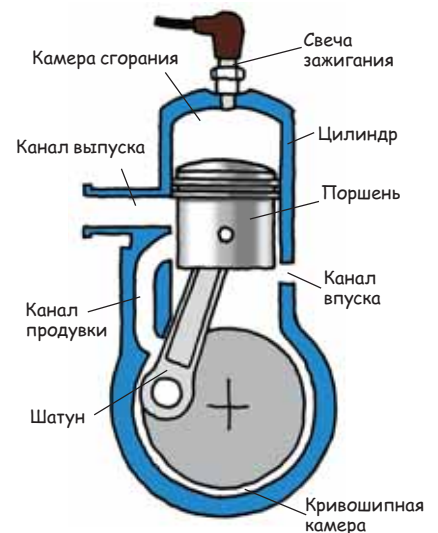
Простейший двухтактный двигатель
