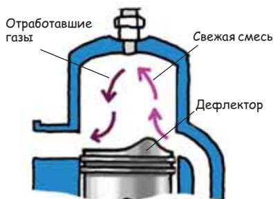
Принципиальная схема дефлекторной продувки
