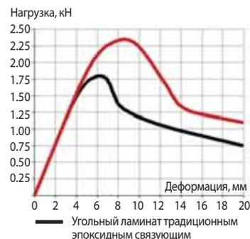
Сравнительный график деформации под нагрузкой образцов углеродного ламината, пропитанных обычной эпоксидной смолой и новым наносвязующим
