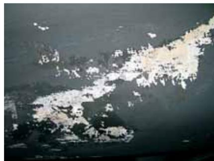
Разрушение ремонтного слоя краски в районе осмотических изменений в обшивке днищевой части корпуса яхты «Princess 52» 1998 г. выпуска
