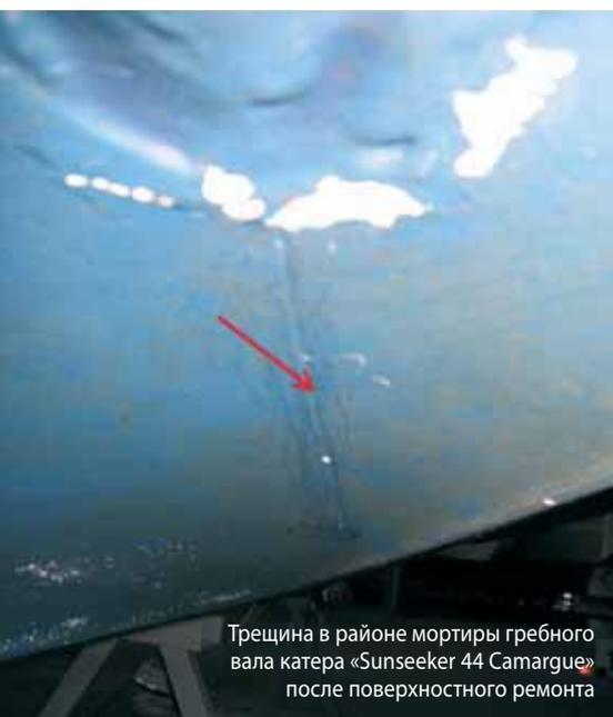
Трещина в районе Mortиры гребного вала катера «Sunseeker 44 Camargue» после поверхностного ремонта
