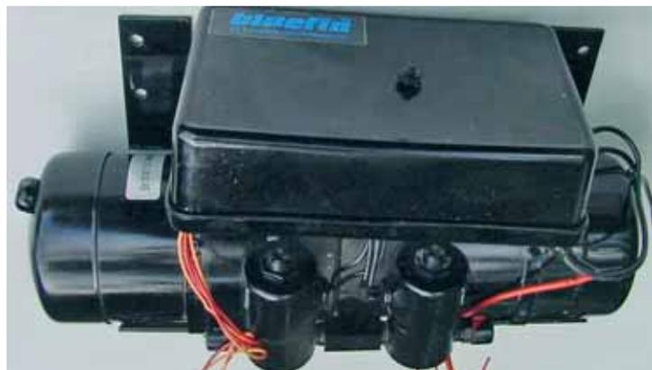
Рис. 4. На небольших прогулочных судах обе плиты приводятся одной гидромомпой, объединенной в компактный блок с электромотором, накопительным бачком и электромагнитными клапанами
