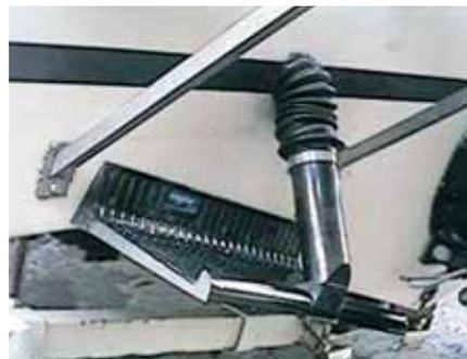
Рис. 7. Гофрированный чехол должен закрывать всю рабочую поверхность выдвижного штока, что обеспечивает дополнительную защиту от обрастания и износа
