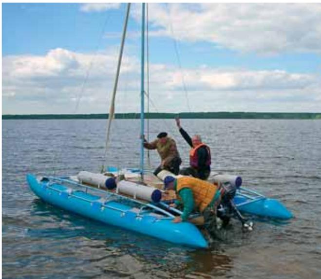
Гибкая палуба, изготовленная из ПВХ-ткани удельным весом 1200 г/см<sup>2</sup>, установлена между первой и третьей поперечными балками и служит для размещения палатки экипажа и груза. Палатка – из водонепроницаемой ткани, установлена на опорах «пирамиды» и имеет носовую и боковые иллюминаторы. Конструкция палатки исключает попадание воды внутрь даже при «накрытии» ее волной.
