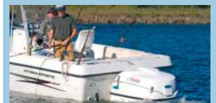
Такие «приставные» блоки с водометными движителями под названием «JetPac» («реактивный рюкзак») производит американская компания «Sword Marine Technology». Мощность используемых бензиновых и дизельных двигателей – от 150 до 300 л.с.
