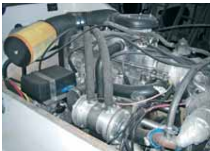
Сам по себе ВАЗовский мотор был основательно доведен до ума, но из типовых мер по конвертации его в судовой была осуществлена лишь замена выпускного коллектора на охлаждаемый
