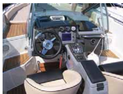
Серьезный мореход «Buster XXL AWC». Необычное решение рулевой консоли: верхняя панель вместе с приборами заваливается в запираемый ящик.
