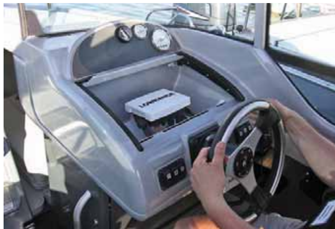
Серьезный мореход «Buster XXL AWC». Необычное решение рулевой консоли: верхняя панель вместе с приборами заваливается в запираемый ящик.
