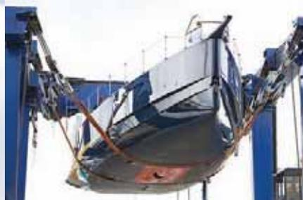
Корпус яхты на подвесах перед монтажом киля. Хорошо видны углубления в днище в районе шарнира.
