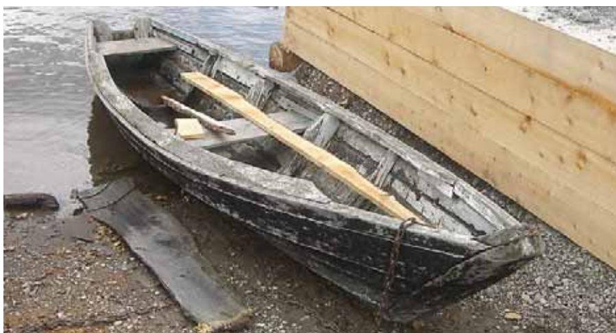
Лодка с берегов залива Айрыташ – с тесаным набором и мощным привальным внутренним брусом
