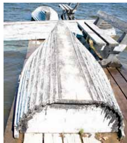
Вместо простых дощатых наборов на Бии делают и более трудоемкую клинкерную обшивку
