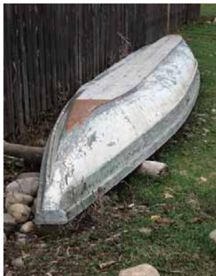
«Народный композит»: лодки с обшивкой из оцинкованной жести на днище-плахе и деревянном наборе
