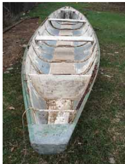
«Народный композит»: лодки с обшивкой из оцинкованной жести на днище-плахе и деревянном наборе
