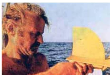
Рис. 5. Это примитивное приспособление позволяло участникам экспедиции на тростниковом паруснике «Ра» достаточно уверенно ориентироваться в океане. Название «носометр» (придумано нашим соотечественником Юрием Сенкевичем) было навеяно тем, что в одной из шарнирно соединенных дощечек предусмотрено специальное углубление для носа наблюдателя.
