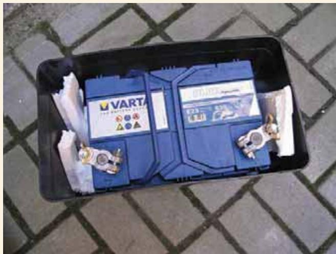
Аккумулятор «Varta» прожил один сезон в содружестве с разными моторами. Бокс оправдал ожидания. Конструкция позволяет без опаски размещать его прямо в кокпите открытой лодки. Даже упавший «газовый ключ» не вызовет короткого замыкания. Есть возможность подключения потребителей снаружи как на клеммы, так и используя гнезда (типа прикуриватель). Для того чтобы батарея не перемещалась внутри бокса использованы обломки пенопласта – просто и практически даром, но получилось надежно.
