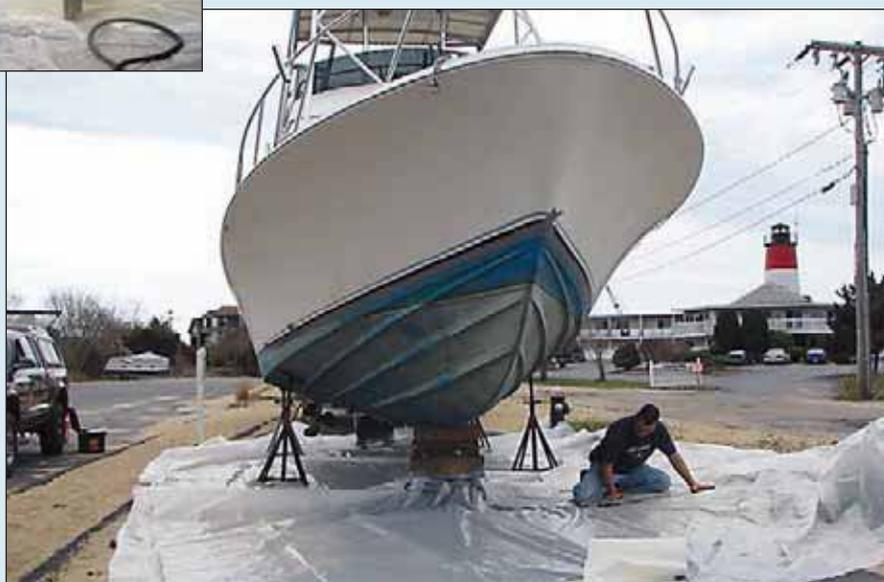
Этот нетоксичный экологически безопасный способ пригоден и для очистки днища пластикового судна от старой краски. В данном случае гелькоут остается неповрежденным, что является заметным шагом вперед по сравнению с общеизвестными химическими и механическими методами очистки.
