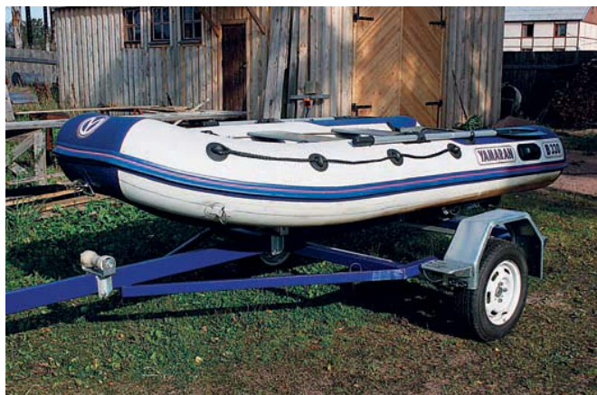
Для перевозки мы использовали автомобильный трейлер МС-750
