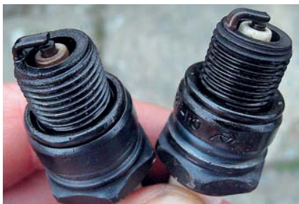
Второй комплект с неисправной свечой (справа). На правой свече электрод «утоплен» в изолятор.
