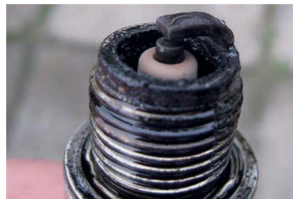
На электроде хорошо видна капелька воды, которая в соответствии с инструкцией не является криминалом (после часа на самых низких оборотах)
