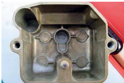
В один из моментов в поплавковой камере появилась эмульсия – грешим на бензин
