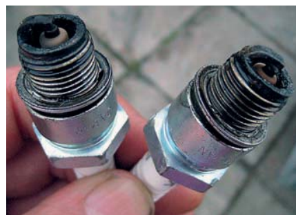
Свечи NGK после часа работы на самых низких оборотах и смеси 40:1
