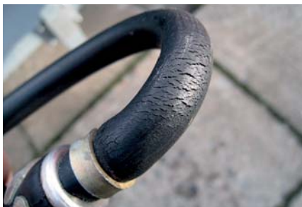
Мелкие трещины не всегда безобидны
