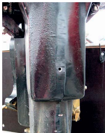
Отверстие, которое произвело чудо... Нижний цилиндр пока «не сосет» воду.
