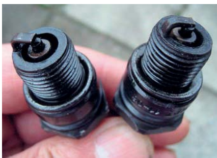
Первый комплект с неисправной свечой (справа)
