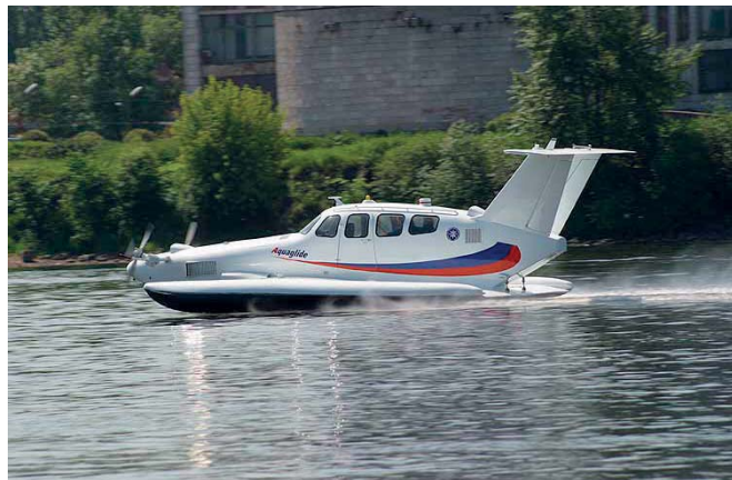
Экраноплан «Аквaглайд». Развивает скорость 130–150 км/ч.
