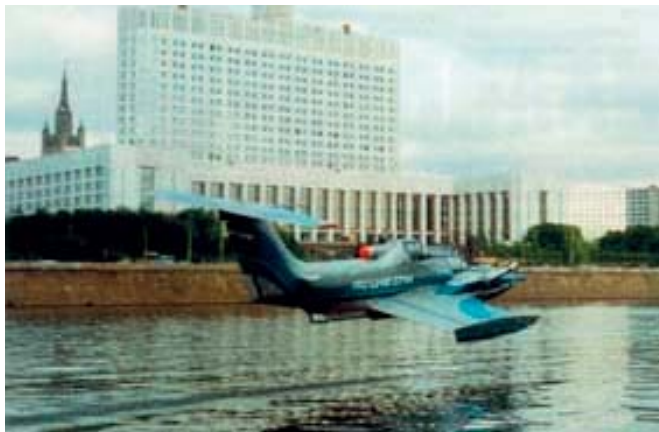
Экраноплан «Стриж» массой 1,4 т. Развивает скорость 170 км/ч.
