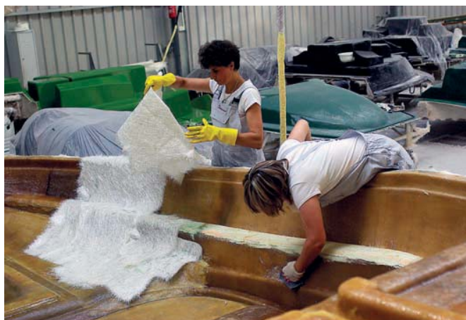
Стекломаты по-прежнему часто служат для набирания толщины обшивки
