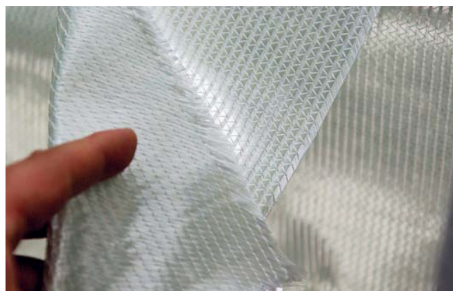
Используемые сегодня стеклоткани и мультиаксиальные волокна имеют различные, порой весьма сложные, типы переплетения
