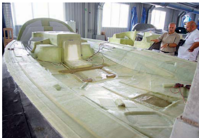
Вакуумное и инъекционное формование сегодня – одни из основных методов в яхтостроении
