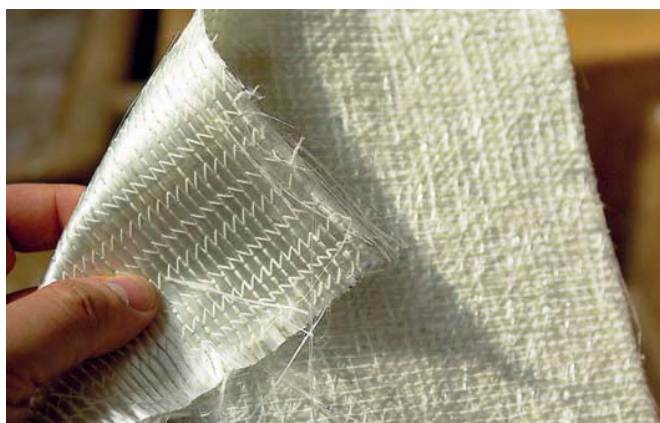
Используемые сегодня стеклоткани и мультиаксиальные волокна имеют различные, порой весьма сложные, типы переплетения
