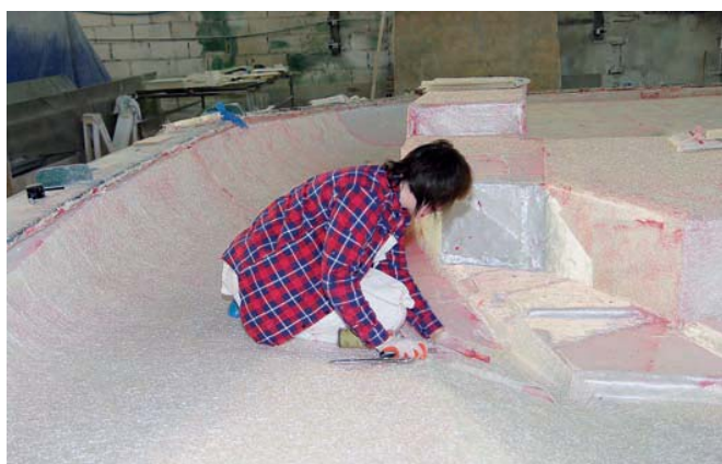
Для приформовки деталей к уже отвержденной «корке» используются специальные смолы и клеи с высокой адгезией, дополнительно подкрашенные контрастным красителем для удобства работы
