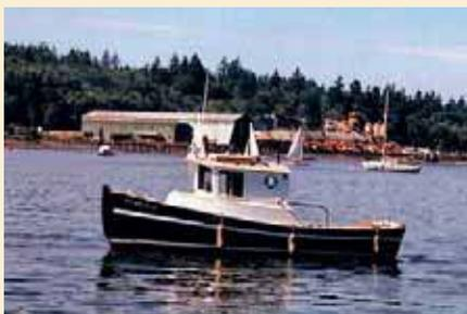
**Катер «Dipper»** Сэма Девлина. Длина – 5,1 м, ширина – 2,2 м, водоизмещение – 590 кг, мощность подвесного двигателя – 10–15 л.с., скорость – 7–8 уз.
