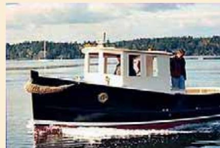
**«Godzilla 22»** – настоящий малый буксир со стационарным дизелем, хотя и с неплохой обитаемостью. Длина – 6,7 м, ширина – 2,5 м, водоизмещение – 1360 кг.
