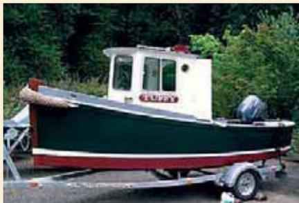
«**Godzilli 16**» Девлина размерами близок у «Dipper», но более ориентирован на рабочее применение. Водоизмещение – 540 кг, мощность подвесного мотора – 20 л.с.
