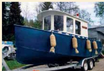
«**Лобстреп**» Василия Румянцева выгодно отличают прочный алюминиевый корпус и трейлерные габариты (2.5 м ширины) при уже достаточной для «малого крейсера» длине 6.5 м. Мотор – подвесной, «Tohatsu-30».
