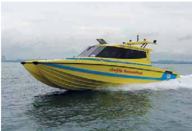
Рис. 2. Катамаран-спасатель «R38». Длина – 12,2 м; ширина – 3,8 м; двигатели – 2х315 л.с.; максимальная скорость – 38 уз. Используется для патрулирования Андаманского побережья Таиланда и оказания оперативной помощи терпящему бедствие судну; снятия с него людей до подхода основных сил спасателей. Оборудован средствами оказания реанимационной помощи.
