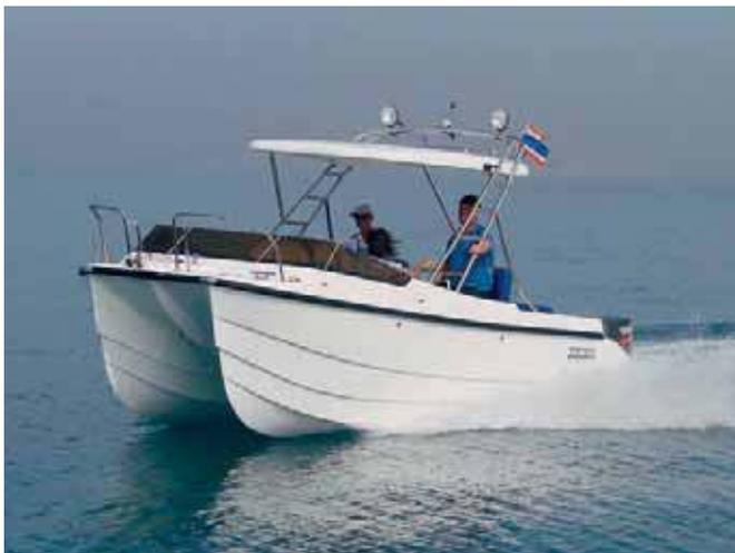
Рис. 1. Катамаран пр. «С620». Серийно строится для азиатского, австралийского и европейского рынков. Спроектирован «под 40-футовый контейнер» – в него при перевозке помещаются два катамарана, у которых кормовая часть корпуса (так называемый «род») сделана съемной и крепится на болтах. Длина корпуса (с кормовой секцией) – 5,70 (6,20) м, ширина – 2,30 м; ПМ – 2 х (85–115) л.с.; скорость – до 40 уз.
