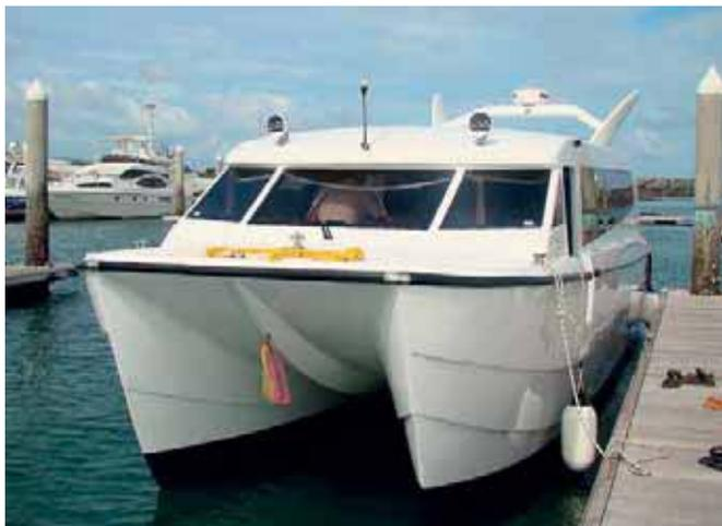
Рис. 6. Катамаран «FC1000» в исполнении «водное такси». Длина – 10,0 м, ширина – 3,3 м, пассажироместность – 20–30 чел. Эти суда эксплуатируются в Таиланде, на Филиппинах, в Камбодже и Нигерии. На фото хорошо виден носовой волнорез.
