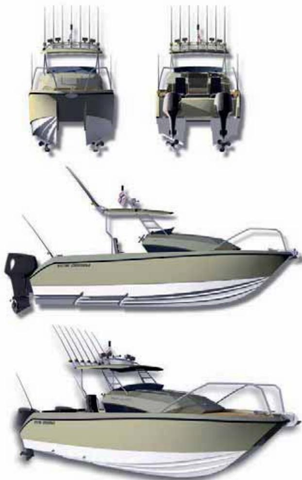
Рис. 11. Катамаран «STC790 Crocodile» в стиле «милитари» с корпусом типа «split-hull» и поперечными реданами. Предназначен для любительской рыбной ловли. Длина – 7,90 м, ширина – 2,57 м, ПМ – 2х(100–160) л.с., расчетная скорость – до 50 уз.
