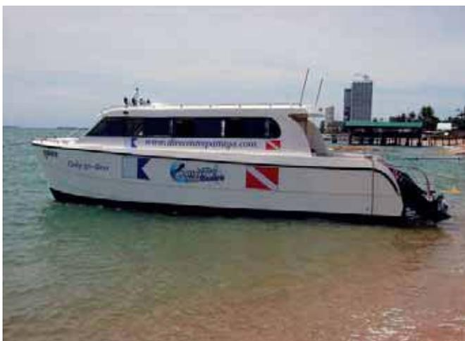
Рис. 3. «Дайверский» рабочий катамаран «FC1000». Длина – 10,0 м, ширина – 3,3 м, пассажироместность – 18 чел. с оборудованием и 2 члена экипажа, макс. скорость – 38 уз; ПМ – 2х50 л.с.
