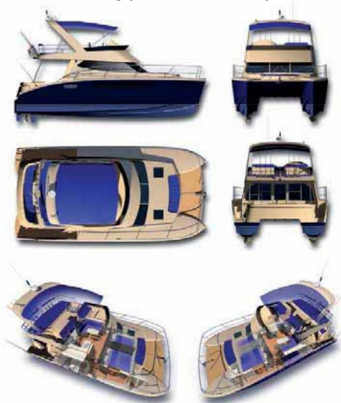
Рис. 10. Катамаран «AR980 Arbalist». Спроектирован на глиссирующий режим движения, эффективен и в переходном режиме. Длина – 9.80 м, ширина – 5.00 м, двигатели – 2х(110–190) л.с., расчетная скорость – до 34 уз.
