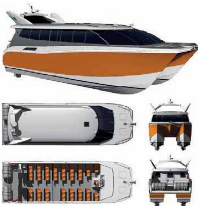
Рис. 4. Катамаран-паром «NF1300». Предназначен для перевозки пассажиров в прибрежных акваториях и заливах. Длина – 13,37 м, ширина – 4,50 м, водоизмещение порожнем – 9500 кг; стац. двигатели – 2х(550–715) л.с.; расчетная скорость – до 45 уз.
