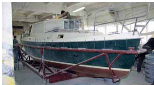
«Haber 800C4» на завершающей стадии постройки. Хорошо видна наделка в носу, в которой скрывается носовой швертовый колодец.
