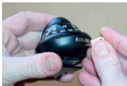
Рис. 7. Встроенный девиационный прибор («built-in compensators») большинства компактных компасов представляет собой пару винтовых верньеров с установленными на них магнитиками. Вращать винты следует только специальной немагнитной отверткой, имеющейся в комплекте.
