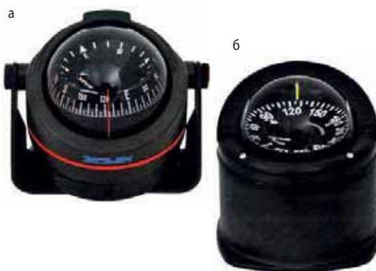
Рис. 10. Конструкция большинства лодочных компасов предусматривает возможность наклона котелка в ДП, что позволяет устанавливать прибор на вертикальной, горизонтальной и наклонных плоскостях (а), хотя есть модели, рассчитанные только на горизонтальные или вертикальные поверхности (б). Курсовая черта может располагаться не только в корму (а), но и в нос (б) от соответственно ориентированной картушки, а то и вовсе под углом – какой вариант окажется удобнее с точки зрения хорошего обзора с места рулевого, решать вам «по месту».
