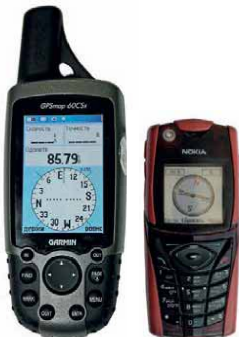
Рис. 5. Приемники GPS и даже некоторые мобильники оборудуются и магнитным компасом с «виртуальной» картушкой, не зависящим от сигналов спутников
