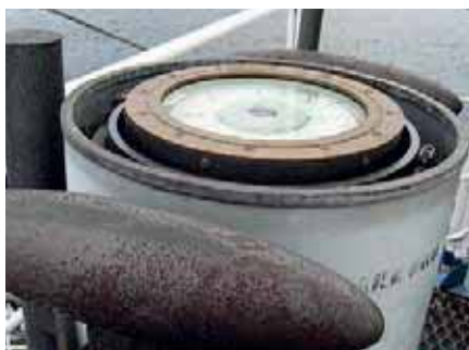
Рис. 11. Яхтенный компас на кардановом подвесе уверенно работает при глубоких кренах
