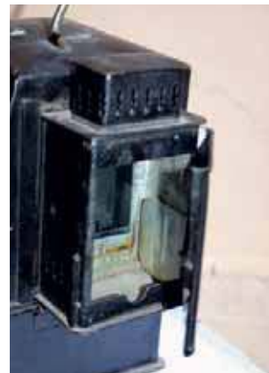
Рис. 9. Этот отсек классического шлюпочного компаса предназначен для установки масляного светильника или обыкновенной свечки.
