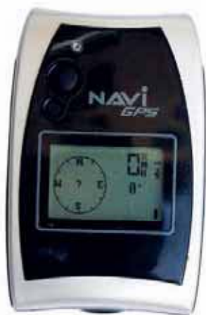
Рис. 4. Принимающий сигналы спутников «компас» приемника GPS указывает на географический (а не на магнитный) север и работает только на ходу.
