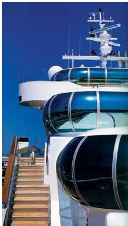
Рис.1. Остекление лобовых стенок надстроек и рулевой рубки яхты «Есо», 74.5 м, 1991 г.
