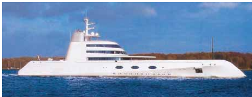
Рис.2. Мегаяхта «А», построенная в 2008 г. на верфи «Blohm&Voss». Размеры яхты – 119,0×18,9 м, осадка – 5,15 м, рег. Вместимость – 5959 бр. рег. т. Главные двигатели – «MAN RK280» мощностью 2×9000 кВт. Дальность плавания при скорости 15 уз – 6500 миль.
