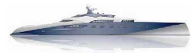
Рис.4. Проект 115-метровой яхты Беркли Марча, в котором предусмотрено использование водорода в качестве топлива для двигателей. Форштевень с обратным уклоном дополнен в подводной части бульбом.
