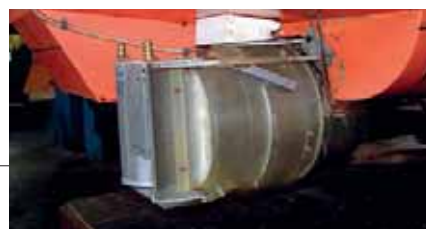
Рис. 9. Модель двухканального МГВД; реверсивные заслонки в положении «передний ход»
