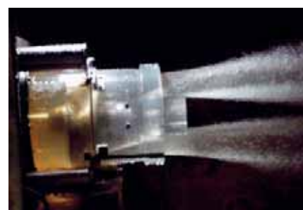
Рис. 6. Струя, истекающая из двухканального сопла движителя
