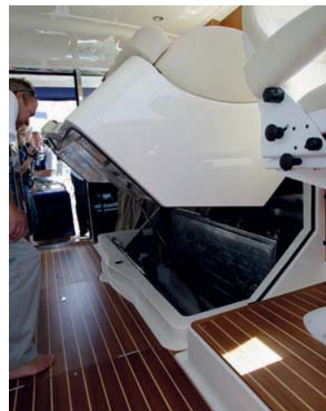
Двигатели закрыты мощной шумоизоляцией и прячутся под диванами салона
