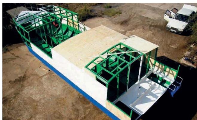
справа от прохода расположены ходовая рубка, галюн и четыре двухместные каюты. Кают-компания, где за стол могут сесть девять человек и камбуз с газовой плитой и мойкой расположены в центре судна, в открытом кокпите. При необходимости кокпит закрывается быстросъемным тентом. В «речном» варианте судно имеет небольшую осадку корпусом – 0,55 м. Она позволяет заходить в заливы и мелкие речки, подходить к необорудованному берегу носом; трапик с него обычно ложится на берег посуху.
