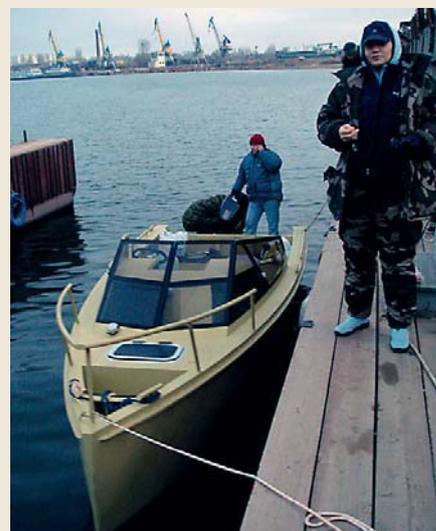
**К**атер, о котором хочу рассказать, построен по мотивам статей Ю.Лобынцева. Владельца (судно строилось по заказу) привлекла концепция водоизмещающего судна, которое можно ходить с комфортными скоростями при умеренной мощности мотора и в отсутствие переходного режима. К сожалению, в процессе проектирования нам пришлось отклониться от базовой
