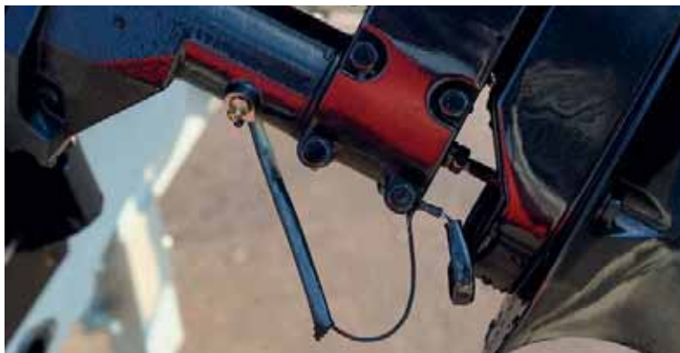
«Минусовые» провода, которыми пренебрегают наши конструкторы, играют большую роль, особенно если на моторе установлено мощное электронное зажигание
