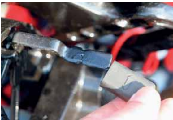
Мягкая накладка на рычаге механизма откидки мотора слабо держится. Есть риск ее потерять. Поэтому сразу лучше накладку чем-нибудь закрепить, к примеру, изолентой.
