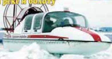
Корпус изготовлен из стеклопластика с применением авиационных технологий и только у ПАТРУЛЯ защитен износостойким, амортизирующим адаптивным днищем, запатентованным и не имеющим аналогов в мире. Такое днище позволяет азросаним без всяких повреждений переходить по острым торосам, кочкам, переходным средам. ПАТРУЛЬ сертифицирован и выдана серия ПТС для регистрации в Ростехнадзоре.
