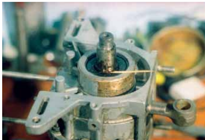
Фото 6. Набивка смазки в канавку между шейкой коленвала и манжетой
