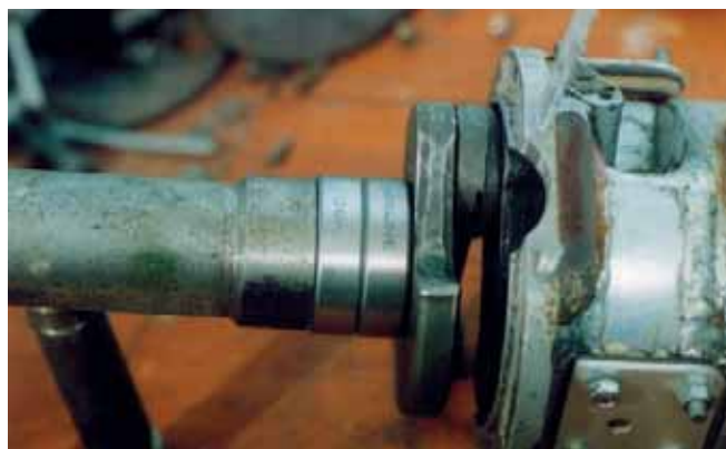
Фото 2. Запрессовка шарикоподшипников № 205 специальной оправкой
