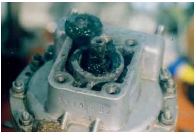
Фото 5. Набивка смазкой на основе дисульфида молибдена полости между манжетами коленвала
