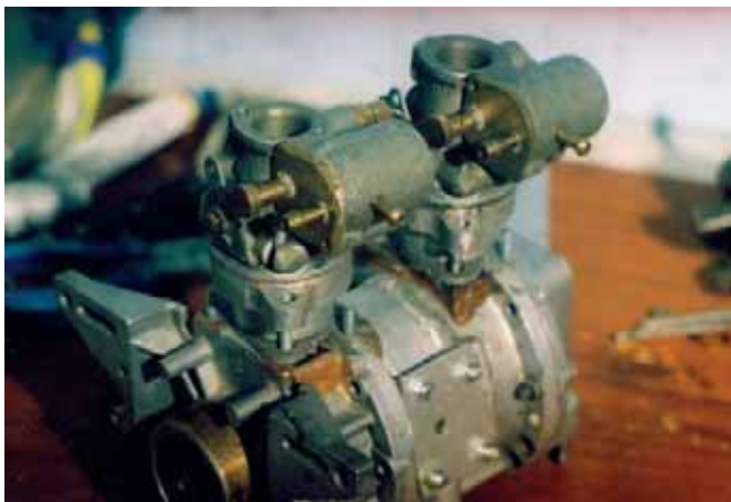
Фото 7. Прямоточные карбюраторы, установленные на картере в передней его части
