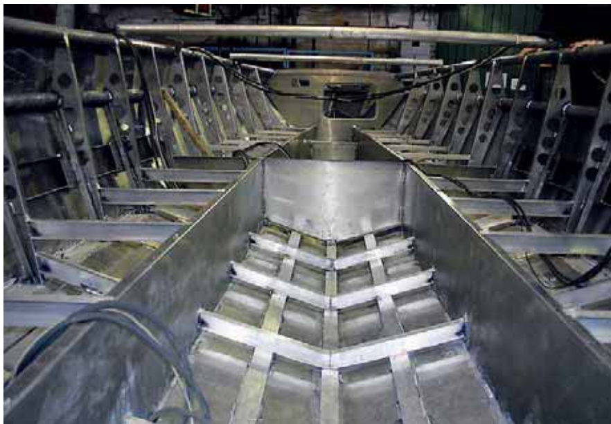
Пример ответственного отношения конструктора к прочности сварного корпуса: в наличии мощный продольный набор и выраженные шпангоутные рамы
