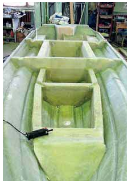
На хорошо организованном серийном производстве стеклопластиков жизнь бьет ключом. Справа: днище скоростного пластикового катера должно быть усилено мощным продольным и поперечным набором.
