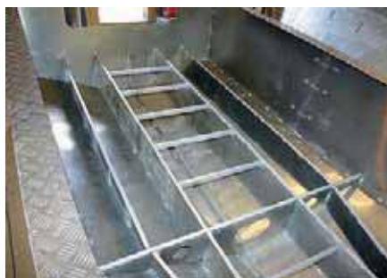
Если обшивка имеет достаточную толщину, ребра жесткости заменяют более частые продольные балки-стрингеры
