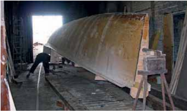
Рис. 2. Корпус из трех сопряженных панелей отличаются более широкие возможности формообразования
