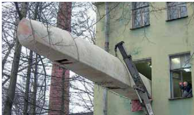
Рис. 1. Корпуса, сформированные из двух фанерных панелей наиболее надежны, просты и технологичны в постройке
