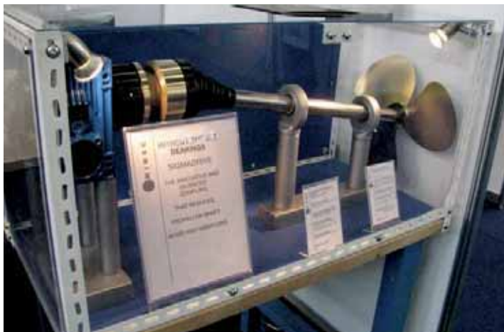
Муфты «Unimes» допускают установку гребного вала без упорного подшипника
