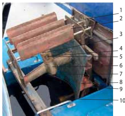
**Рис.5.** Откидной винторулевой комплекс (ВРК) катера «Улисс» (в откинутом положении)
