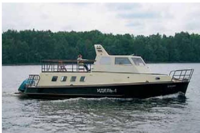
Рис.2. Прогулочный катер на основе адмиральского (см. «КиЯ» №209). Основные характеристики адмиральского катера: длина – 12 м, водоизмещение – более 8 т, мощность двигателя – 150 л.с., скорость – до 24 км/ч, частота вращения винта – 750 об/мин.
