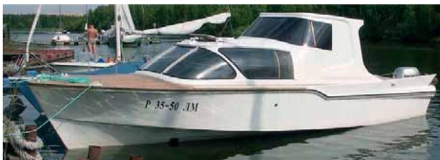
**Рис.4.** Прогулочный катер на основе командирского катера (см. «Кия» №209). Основные характеристики командирского катера: длина – 7.8 м, водоизмещение – 2.4 т, мощность двигателя – 60 л.с., скорость – до 24 км/ч, частота вращения винта – 1000 об/мин.
