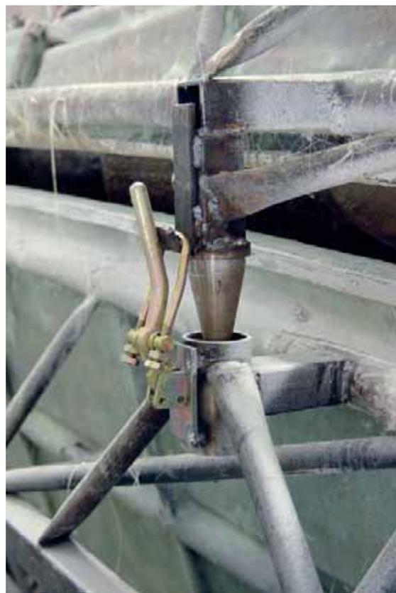
Мощный замок вакуумной матрицы («Modelart»)
