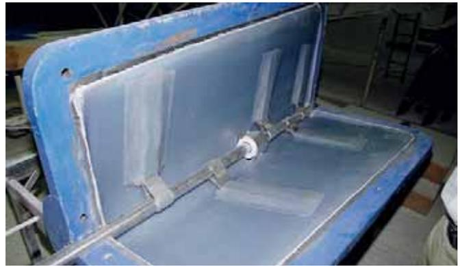
Метод RTM-light позволяет формировать детали с закладными элементами («Amel»)
