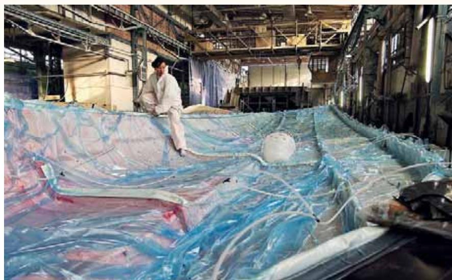
Вакуумные (инфузионные и инъекционные) методы сегодня используются для выклеивания очень больших деталей («Sunreef»)
