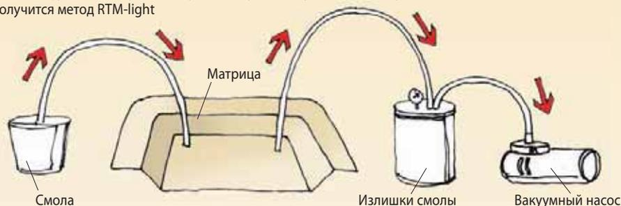
Процесс RTM требует мощного пуансона
