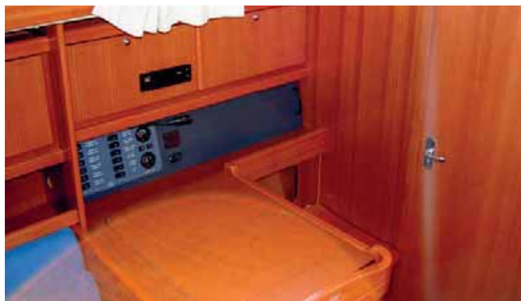
Штурманское место: за панелью кроется доступ ко всем разъемам электроники
