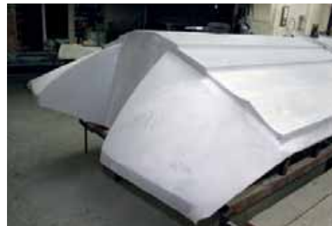
Кормовые оконечности баллонов будут прикрыты снизу жесткими наделками
