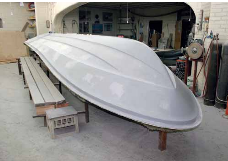
Болван корпуса будущего РИБа проходит финишную обработку
