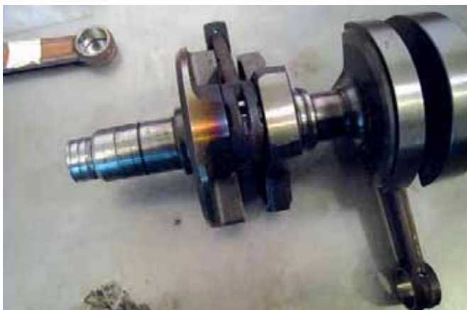
● Перегретая часть коленчатого вала (слева). Хорошо видна побегальность.
