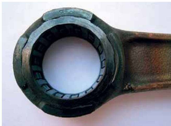
● «Сгоревший» шатун. Коренной подшипник полностью разрушен.
