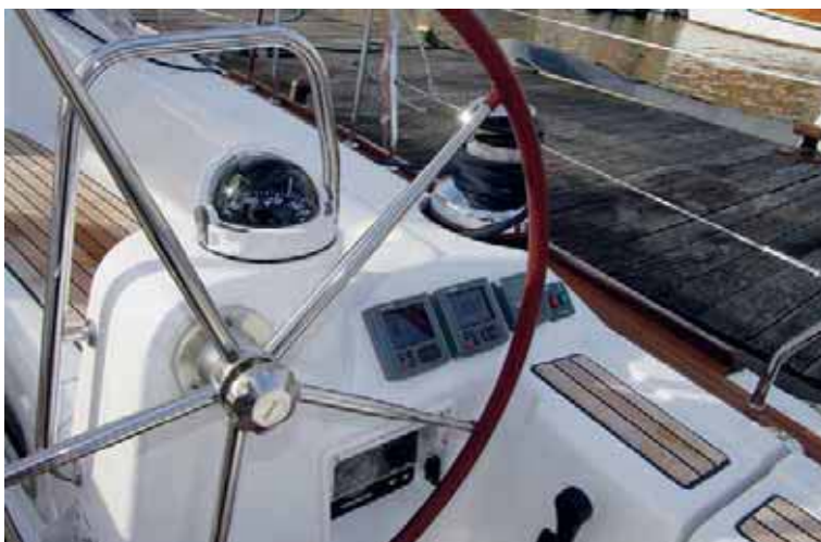
Кокпит: с места рулевого доступны главные шкотовые лебедки. Внизу – поворотный карт-плоттер внизу столика, в дальнем конце – разъем для настольной лампы.
