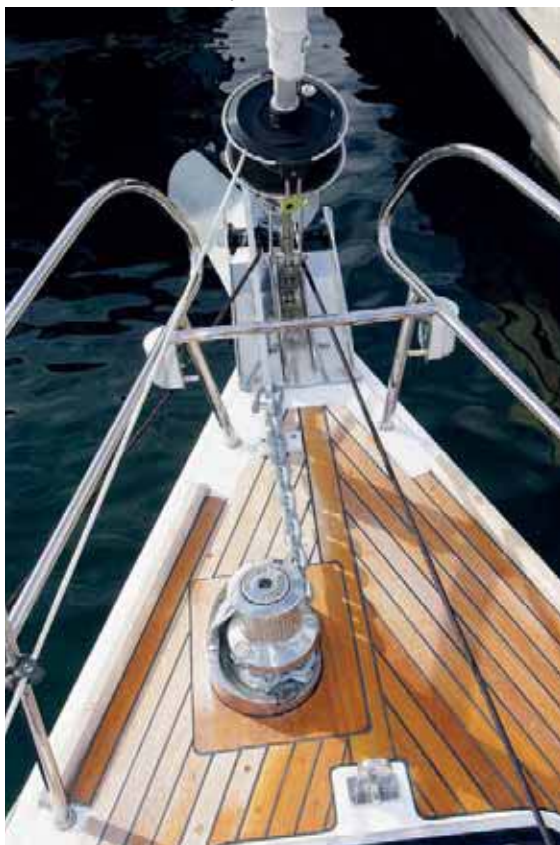
Носовая палуба: якорное устройство с блоком для галса геннакера
