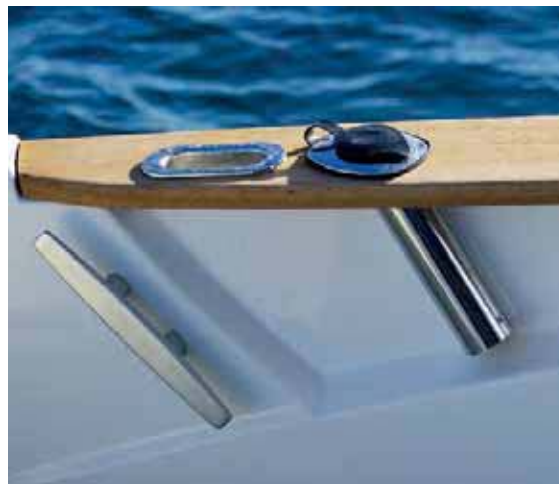
Кокпит: для удочек установлены специальные стаканы, утка утоплена в отформовку, чтобы не запутывалась леска
