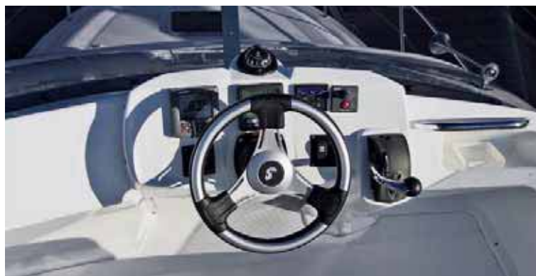
Верхний пост управления: правильное расположение сектора газа
