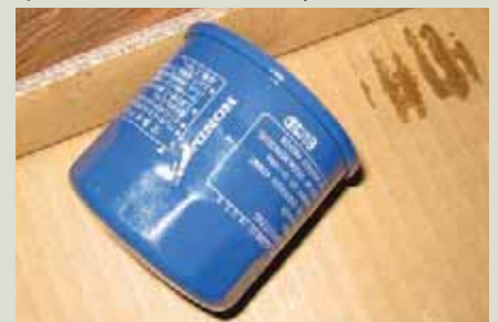
При откручивании порча фильтра оказалась неизбежной, ключ-венчик сохранил бы целостность корпуса
