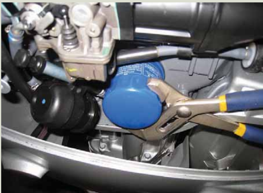
При откручивании порча фильтра оказалась неизбежной, ключ-венчик сохранил бы целостность корпуса
