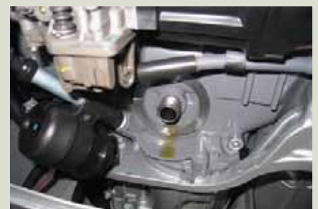
Посадочное место фильтра выглядит достаточно стандартно, поэтому поиски автомобильного аналога возможны, но при определенных условиях
