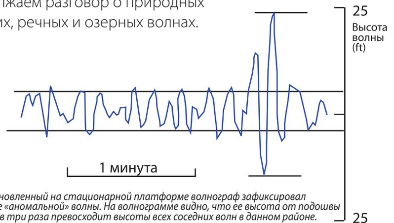
**Рис. 1.** Установленный на стационарной платформе волнограф зафиксировал прохождение «аномальной» волны. На волнограмме видно, что ее высота от подошвы до вершины в три раза превосходит высоты всех соседних волн в данном районе.
