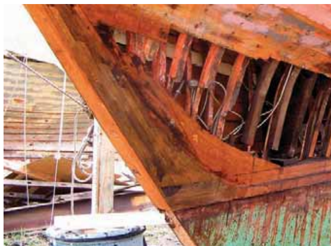
Рис. 6. Готовый ахтерштевень с пристыкованным к нему фальшкилем
