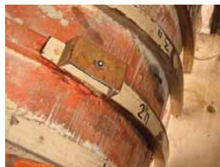
Рис. 8,9. Склеивание «на ус» целой части шпангоута и нового окончания
