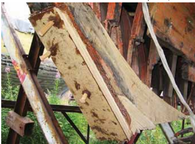
Рис. 5. Деревянные штифты усилили конструкцию нового ахтерштевня
