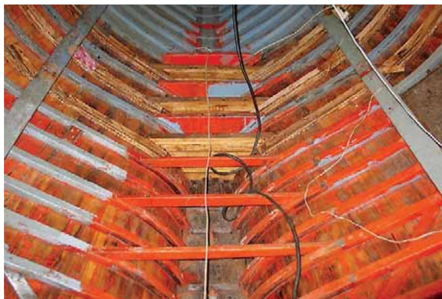
Рис. 13. Новые флоры и шпангоуты на яхте «Арго»
