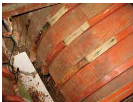
Рис. 8,9. Склеивание «на ус» целой части шпангоута и нового окончания
