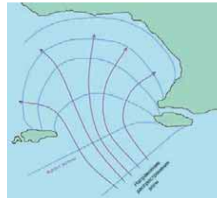
Схема искривления волновых фронтов при проходе пролива между островом слева и мысом справа. «Вливаясь» в залив, волны своими гребнями поворачивают в зоны, закрытые для прямого прохода. При этом высота их уменьшается (но может вырасти при подходе к мелководью), а направление распространения изменяется более чем на 90°.
