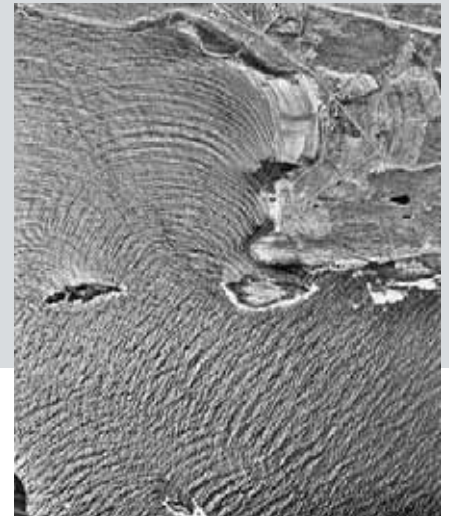
На аэрофотоснимке хорошо видно, что происходит с волновыми фронтами при обтекании препятствий и подходе их под углом к берегу
