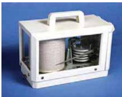
Так выглядит классический барограф с часовым механизмом и самописцем
