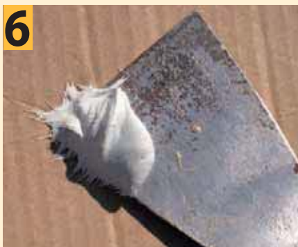
Так выглядит шпатлевка с наполнителем из стекловолокна «Glass Fibre Putty». Иногда ее называют «волосатка», «волосянка» и т. д.
