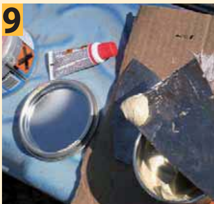
Готовим универсальную шпатлевку. На этом этапе можно использовать и «финальную» шпатлевку. Но мы пошли по наиболее простому варианту, так как универсальная шпатлевка «Novol Universal Putty» предназначена для использования и в других целях.
