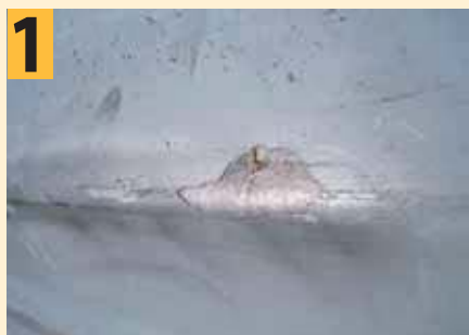
Такой скол необходимо сначала обработать, а потом наложить слой шпатлевки со стеклотканью (в нашем случае – «Novol Glass Fibre Putty»)
