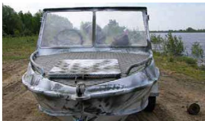
**Рис. 5.** Носовой ролик облегчает работу с якорем, теперь его можно переставлять одной рукой
