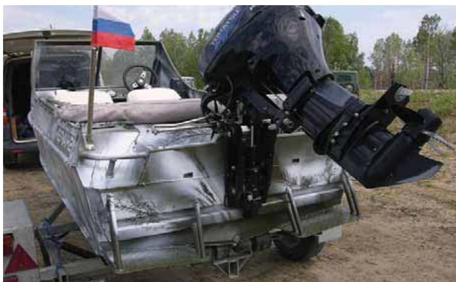
**Рис. 7.** Транец поднят на 12 см для установки «длинного» мотора
