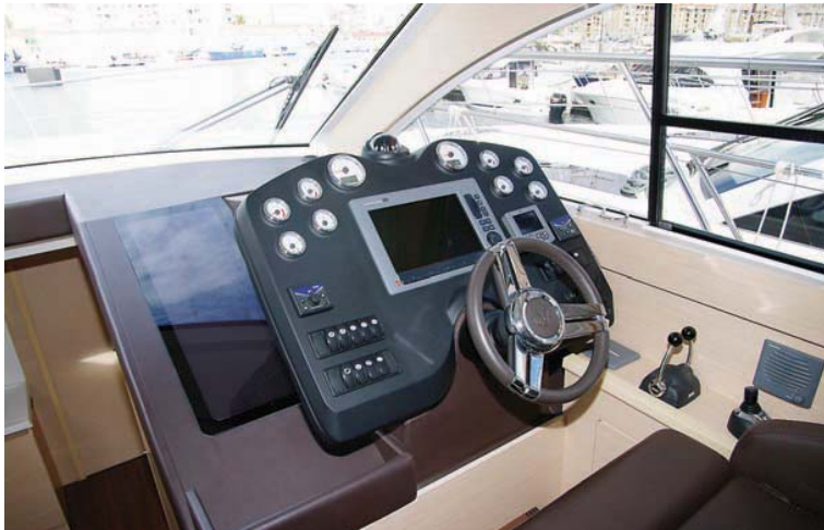
Внутренний пост управления. Справа в углу виден джойстик IPS.
